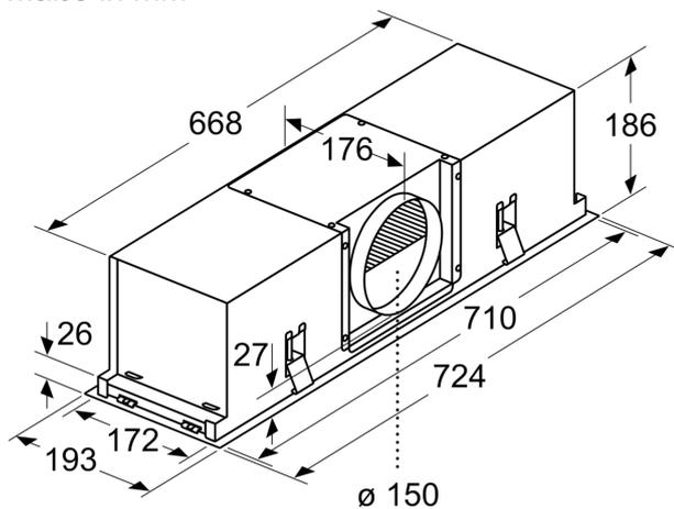
Der Stutzen kann abhängig von der Einbausituation versetzt werden.
