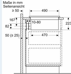
Bei der Installation direkt an einer nicht isolierten Außenwand ( $\mu \geq 0.5 \text{ W/m}^2 \cdot \text{°C}$ ) empfehlen wir die Verwendung von Konfigurationen mit teilweise oder vollständig kanalisierter Rezirkulation.
