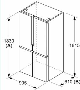
**A:** Front ist von 1830–1847 mm, bei voll ausgezogenen vorderen Nivellierfüßen, verstellbar
